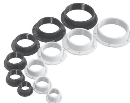
Anneaux de montage avec taraudage de vis intérieur M pour le montage de presse-étoupes M dans le butyl-caoutchouc ou autres matières, ne permettant pas de fileter directement. Données techniques voir page 3!
